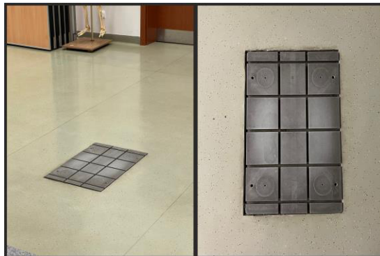
Ryc. 8. Platforma dynamometryczna wykorzystana do pomiarów.
