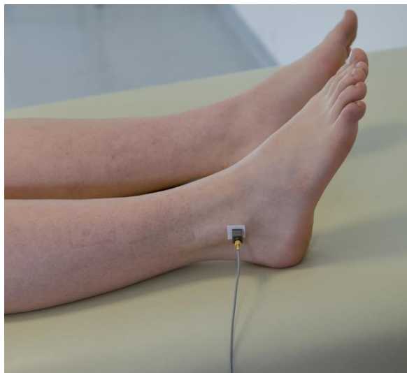
Rycina 7. Umieszczenie czujnika akcelerometrycznego na kostce bocznej kości strzałkowej podczas badania jakości ruchu artrokinematycznego stawu skokowego
