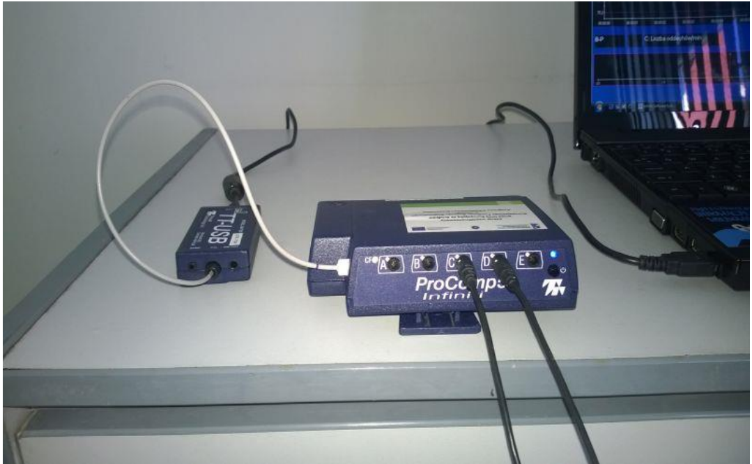
Rycina 1. Koder aparatu BioGraph Infit zbijający dane z czujników
