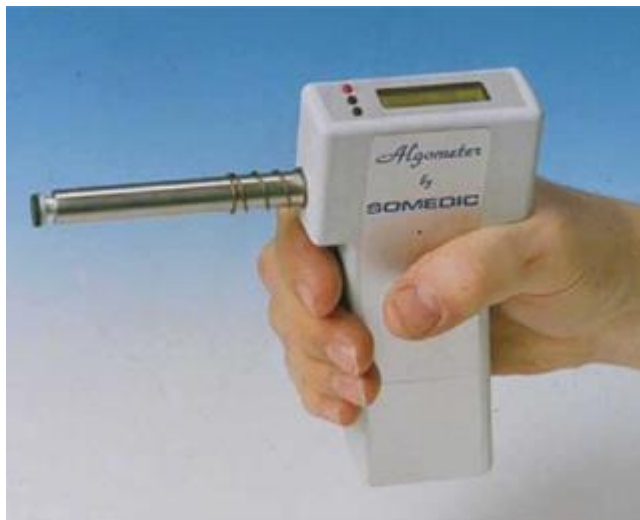
Rycina 3. Algometr firmy Somedic, type II Hörby (Szwecja), ( http://somedic.com/en/algometer.html )
