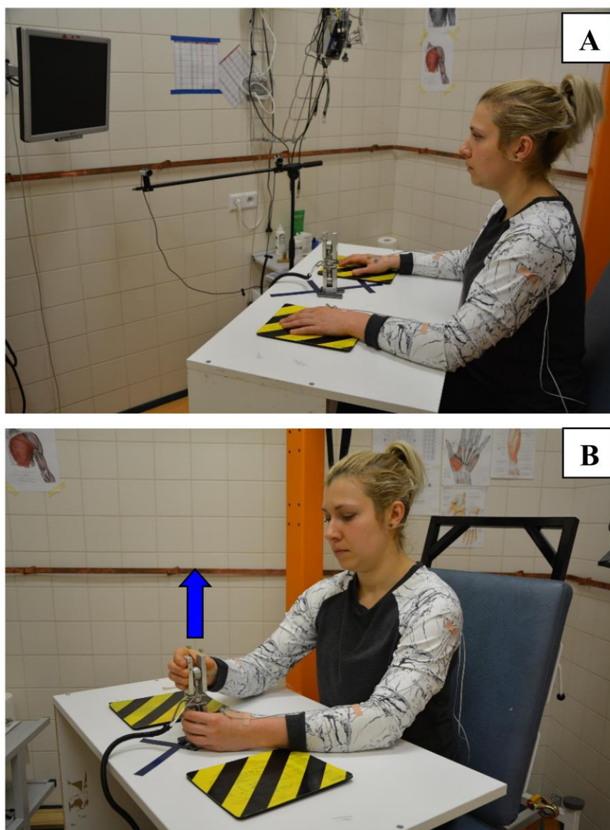
Rycina 3 Stanowisko pomiarowe do badania oburęcznych funkcji chwytnych z osobą badaną w pozycji wyjściowej (Panel A) oraz podczas wykonywania czynności pociągania modułu górnego kończyną manipulującą do góry z jednoczesną stabilizacją modułu dolnego kończyną stabilizującą (Panel B)
