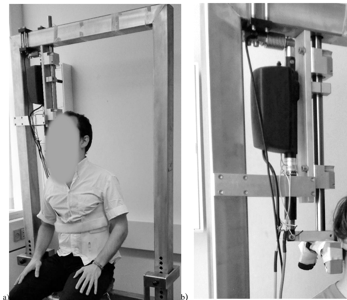
Ryc.4 a, b. Dynamometr do ćwiczeń mięśnia czworobocznego grzbietu (Aalborg University, Aalborg, Dania)
