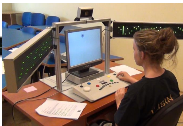
Fot. 1. Wiedeński System Testów, próba PP – pomiar zakresu pola widzenia oraz czasu reakcji na bodziec świetlny pojawiający się w obwodowym polu widzenia.
